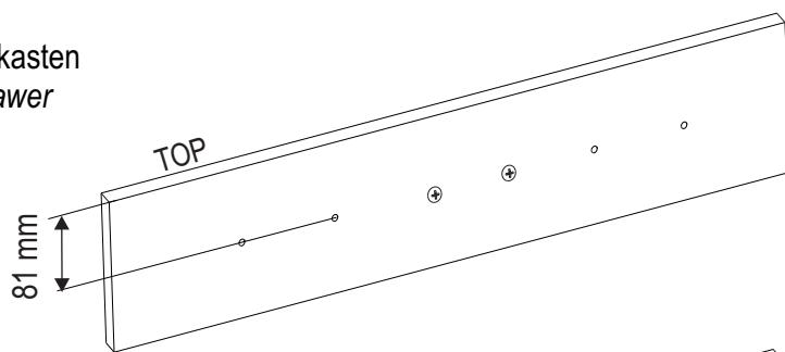
Maße für den Einbau unter einer Arbeitsplatte
