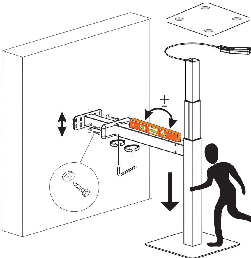
Ausrichten und Ecken mit Klebestreifen markieren. Säule beiseite stellen und Klebepads anbringen und Säule damit fixieren.
