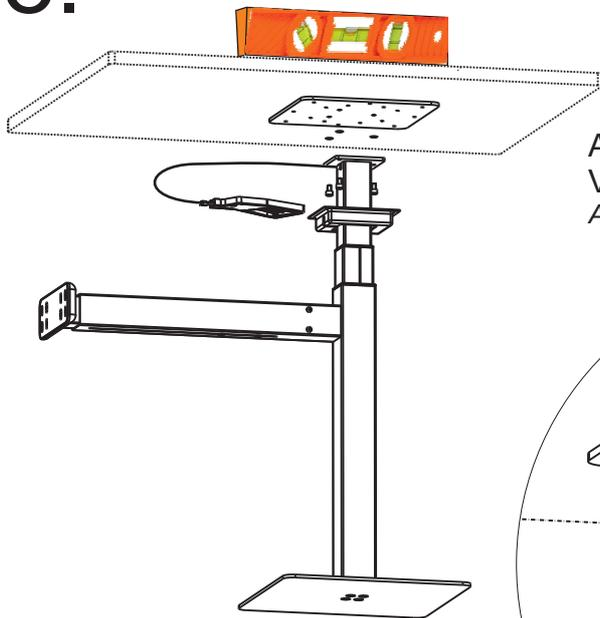
Ausrichten der Tischplatte unter Verwendung von Pass-Scheiben.
